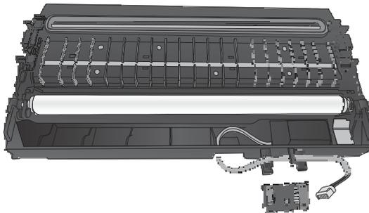
7. Verbinden Sie das Motor Kabel mit der Leiterplatte.
