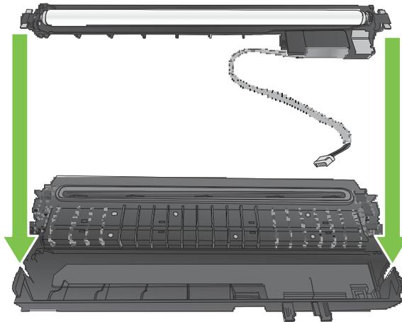
6. Drücken Sie das Kabel in die Halterungen. Drücken Sie die Leiterplatte in die für sie vorgesehene Halterung.
